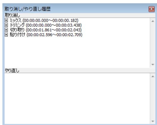
[取り消し] ペインの上部に [ミックス] 操作が表示される点に注目してください。該当するリストの一番上には、常に直前の操作が表示されます。
